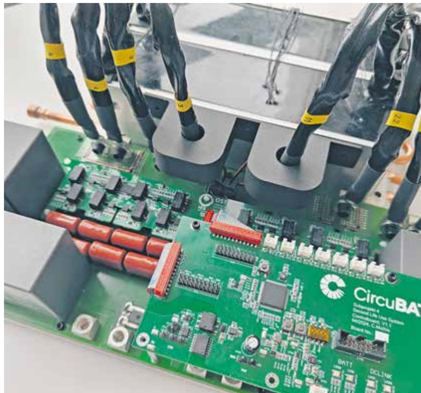
Convertisseur DC-DC développé par OST et IndriveTec AG durant le projet
