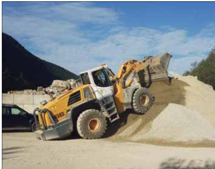
Le granulat (premier plan) réalisé avec le béton de démolition (arrière-plan); ce matériau peut notamment servir à fabriquer des blocs tels qu'on en voit sur la gauche de l'image
