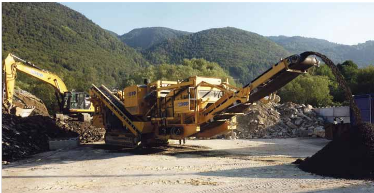
La machine en action mercredi, qui concasse du revêtement bitumeux à recycler, prélevé sur le tas de gauche
