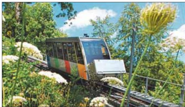
A l'heure où l'on se préoccupe enfin de l'avenir proche de notre planète, le Funiculaire Saint-Imier-Mont-Soleil propose un moyen de transport exemplaire, puisqu'il fonctionne exclusivement grâce à de l'énergie renouvelable. Cette dernière est produite par la descente sur Saint-Imier d'une part, par les panneaux solaires installés sur le tunnel de la station supérieure d'autre part.
